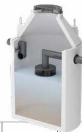
**Anlagenkomponenten:** Monolithischer Betonbehälter, Betongüte C30/37/XA1L/XA2T, mit Flachabdeckung, Konen und befahrbarem Gussdeckel, Zu- und Ablaufbohrung mit SBR-Anschlussdichtung. Zulaufumlenkung, zentrales, getauchtes Abzugsrohr mit radialer Anströmung.
