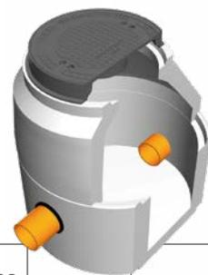
**Anlagenkomponenten:** Betonbehälter, Betongüte C25/30/XF1/XA1L (B2), inkl. Konus und befahrbarem Gussdeckel, Zu- und Ablaufbohrung mit SBR-Anschlussdichtung.
